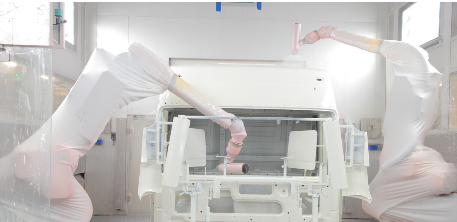
Abb. 11: Lackiervorgang in der Decklacklinie 3
