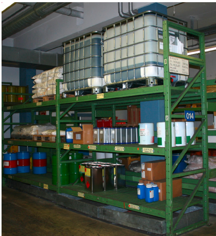
Lagerung von Verbrauchsstoffen im Gefahrstofflager am Standort Gaggenau
